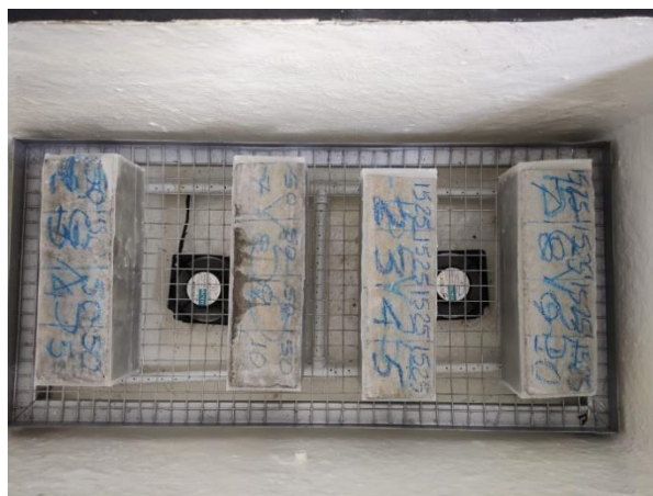
Figura 6.4 - Câmara de carbonatação e corpos de prova prontos para ensaio
