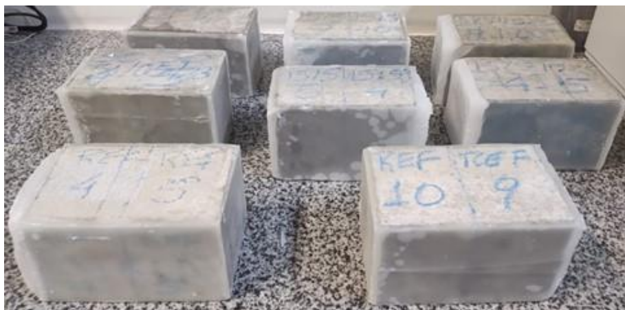
Figura 6.3 - Corpos de prova selados com parafina
