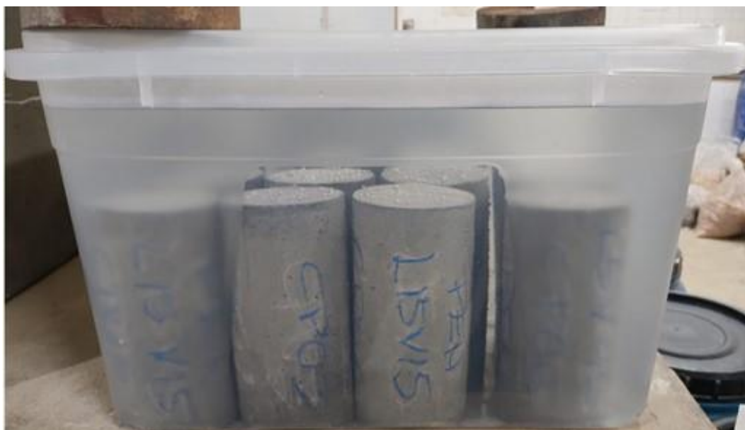
Figura 6.6 - Corpos de prova imersos em solução alcalina
