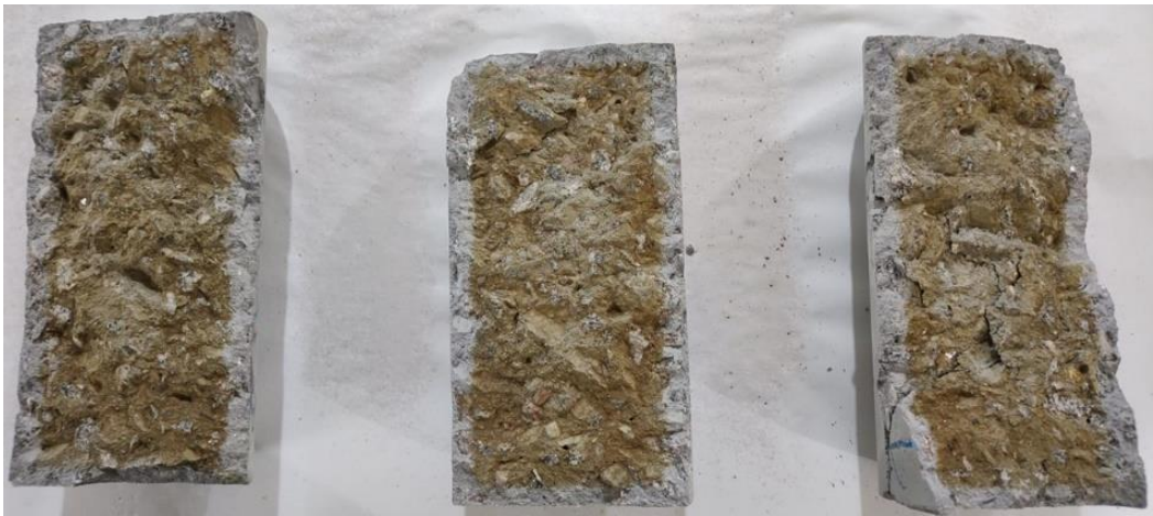
Figura 6.7 - Amostras após a aplicação da solução de nitrato de prata
