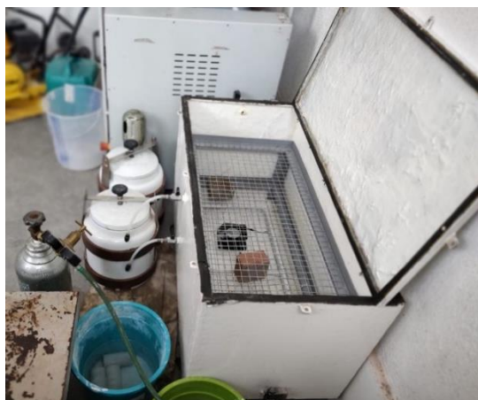
Figura 6.4 - Câmara de carbonatação e corpos de prova prontos para ensaio
