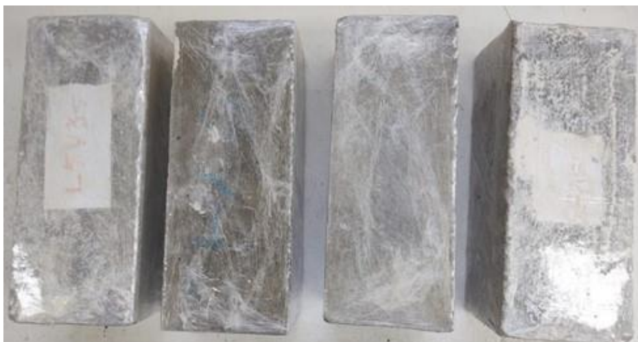
Figura 6.2 - Corpos de prova preparados para o ensaio de carbonatação
