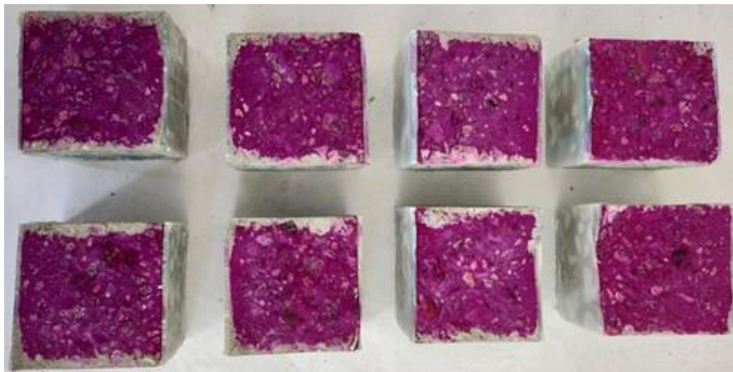
Figura 6.5 - Corpos de prova após aplicação de solução de fenolftaleína
